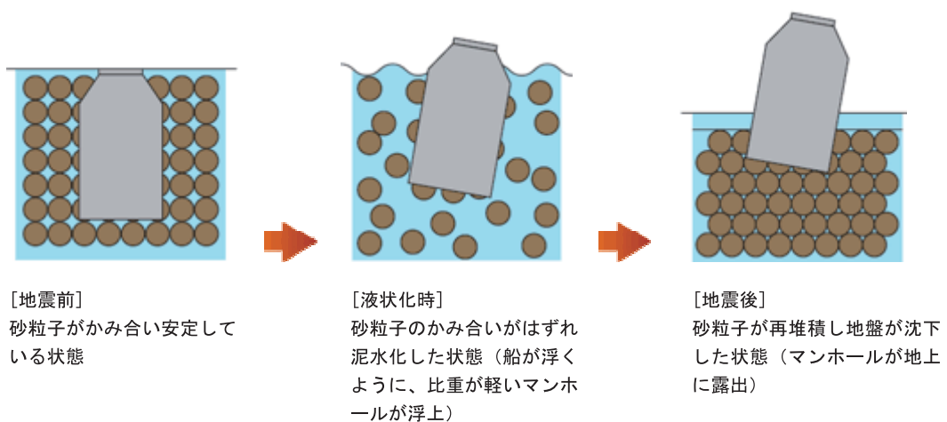
図-16 液状化イメージとマンホール浮上のメカニズム
