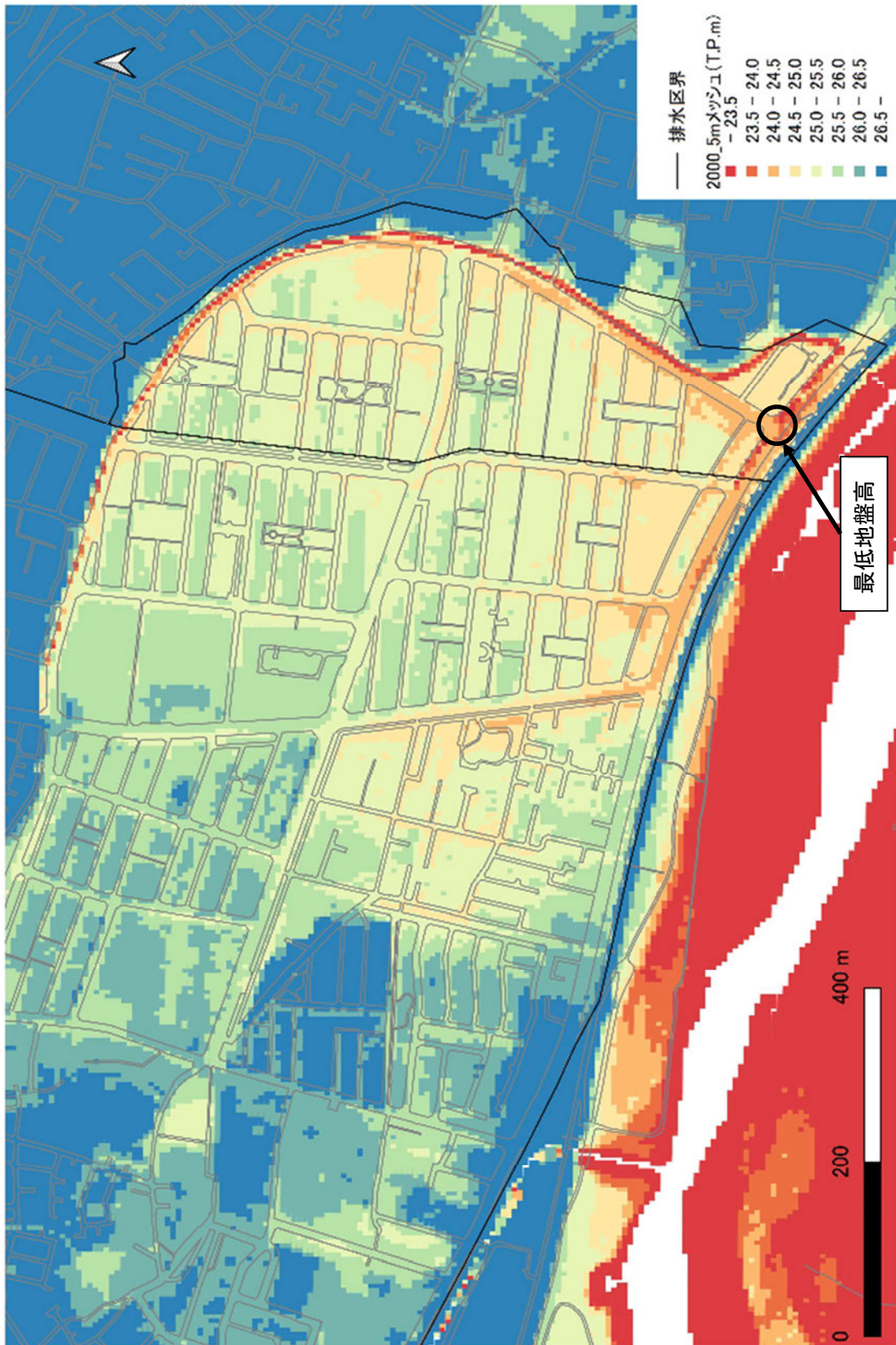
図 7-2-5 根川排水区周辺の地盤高状況
