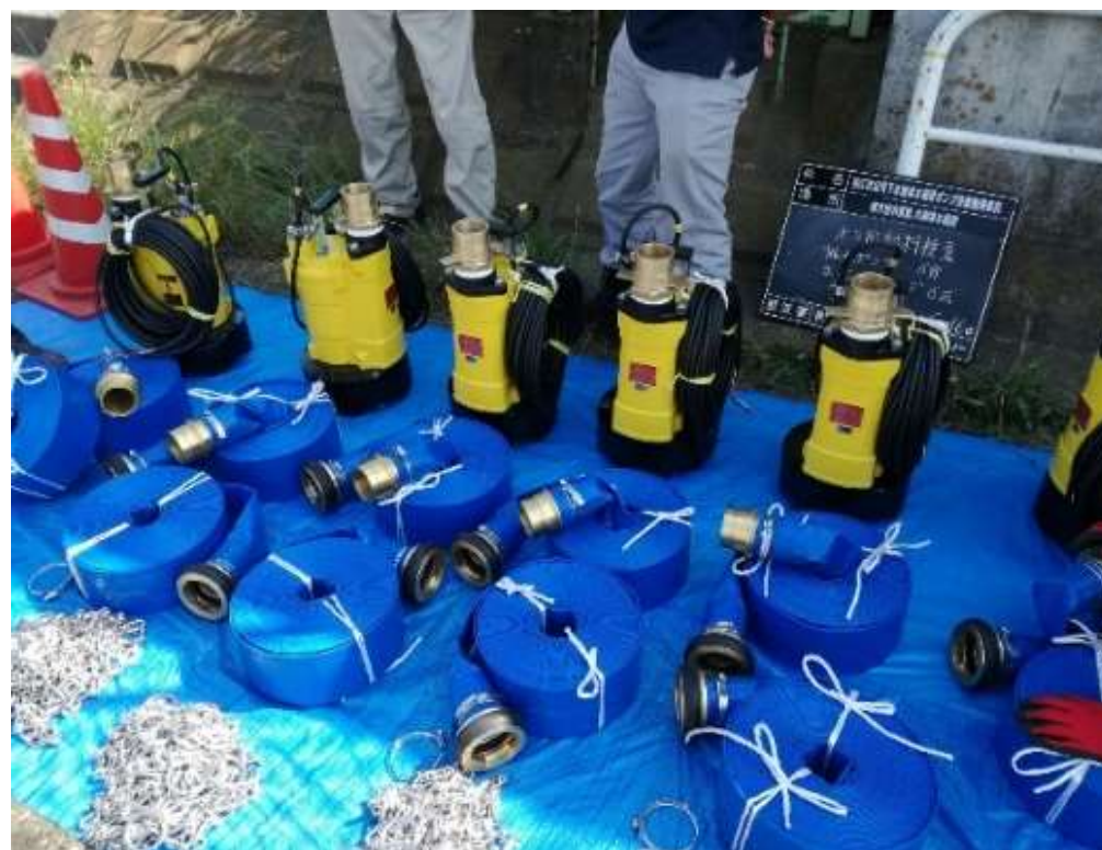
可搬式ポンプ及び排水用ホース
