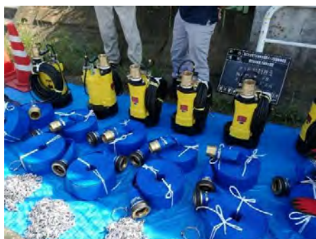
可搬式ポンプ及び排水用ホース
